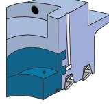
**Descrição:** Labirinto axial, dois retentores ZF de borracha nitrílica e pino graxeiro para injeção de graxa intermediária que elimina as impurezas para a parte externa do conjunto.
