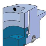
**Descrição:** Labirinto axial e retentor ZF com pino graxeiro para injeção de graxa entre os dois que elimina as impurezas para a parte externa do conjunto.
